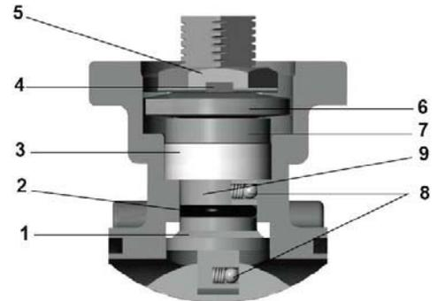
1. **PLATINE DE MOTORISATION ISO 5211 double perçage avec tige carrée** pour flasquage direct.
