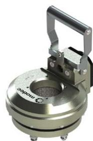
La **tête creuse Heavy Duty** est destinée aux **couples très élevés**. Elle permet le passage de tige jusqu'à un **diamètre maximum de 70 mm** et reste compatible avec tous les systèmes d'accroche pour volant ou autre interface. Enfin, elle apporte une réduction supplémentaire qui permet de **multiplier le couple de l'actionneur par 3** et de réduire la vitesse d'un facteur identique.
