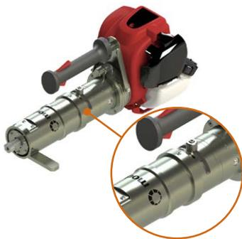
Le **limiteur de couple** pour actionneurs rotatifs portables **moddec** permet de déconnecter le moteur de la boîte de vitesse lorsque la limite de couple est atteinte. La tête de l'actionneur n'a alors plus de couple résiduel appliqué.
