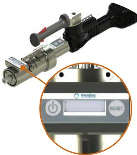
Le **compte-tours digital** additionne les tours dans un sens et les soustrait dans l'autre de manière à ce que l'opérateur sache toujours où il en est par rapport à la situation initiale. Il permet également la **mesure et l'affichage de la vitesse de rotation.**
