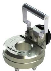
Indispensable pour tous les volants avec **tige montante**, la **tête creuse Standard Duty** permet le passage de tige jusqu'à un **diamètre maximum** de 63 mm. Elle permet également d'utiliser tous les systèmes d'accroche pour volant ou autre interface. Enfin, elle apporte une réduction supplémentaire qui permet de **multiplier le couple de l'actionneur par 4** et de réduire la vitesse d'un facteur identique. Idéale pour les **volants particulièrement difficiles ou grippés**.
