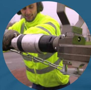
Grâce à nos actionneurs rotatifs portables l'opérateur peut ouvrir/fermer une vanne **sans avoir à forcer**, ou à tourner autour en utilisant un bras de levier.
