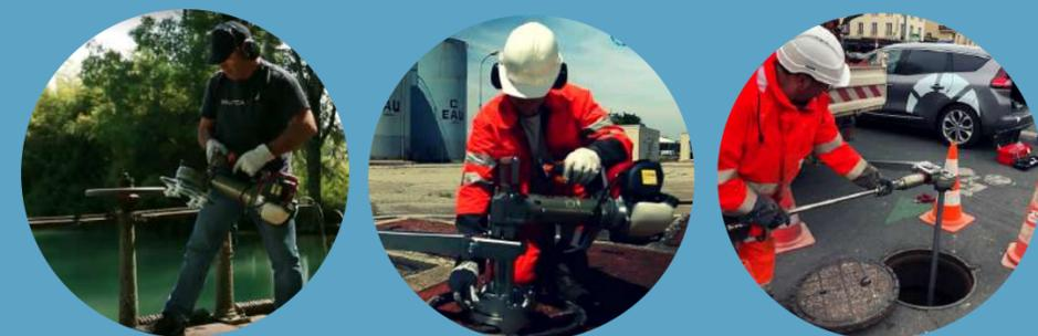
Avec les actionneurs rotatifs portables moddec simplifiez les manœuvres de vannes tout en assurant la sécurité du personnel et du matériel.
